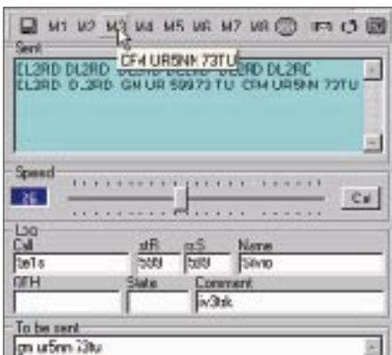
Das CW-Terminal ermöglicht Texteingabe über Tastatur, beinhaltet eine CQ-Maschine und gestattet komfortable Makrodefinitionen; die Gebegeschwindigkeit ist einstellbar. Für Fonisten gibt es etwas ähnliches: Anbindung an den Voice-Keyer [5].
